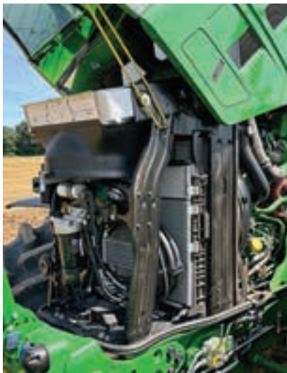
Ο κινητήρας 6,8 λίτρων DPS 220 έχει μέγιστη ισχύς 242 ίππων. Η ώθηση (boost) δίνει 7 ίππους
