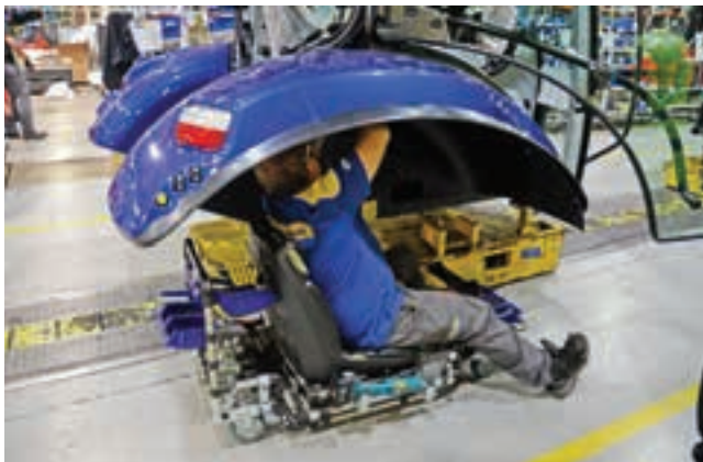
Τα φτερά έχουν μεγάλο βάρος και είναι δύσκολοι στο χειρισμό. Ένας ειδικός χειριστής γι' αυτά αναμένεται να εγκατασταθεί άμεσα στη γραμμή παραγωγής.
