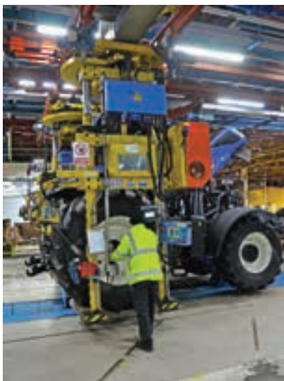
Ένα από τα τελευταία στάδια της συναρμολόγησης περιλαμβάνει την τοποθέτηση των τροχών στο τρακτέρ. Καθώς πλέον μπορεί να στέκεται μόνο του, τοποθετείται σε μία κινούμενη ράγα.
