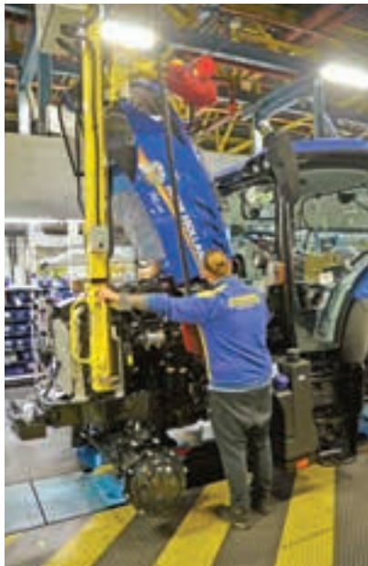
Το καπό τοποθετείται στη θέση του με ένα σύστημα που χρησιμοποιεί βεντούζες. Εδώ ένα T6.145.
