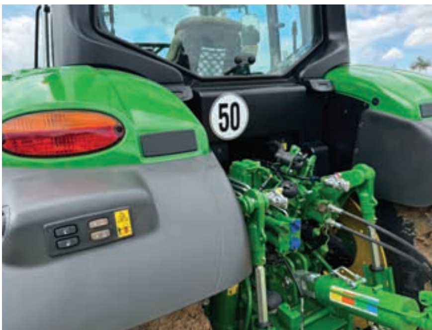
Η σειρά 6M επωφελείται από το ίδιο σχέδιο προφυλακτήρα με το 6R. Ο εξωτερικός έλεγχος βαλβίδων εντοπίζεται εκεί μαζί με τα πλήκτρα δίσκων PTO.
