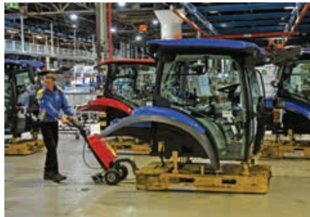
Μετά από στάση σε 25 θέσεις εργασίας η καμπίνα είναι έτοιμη να τοποθετηθεί.
