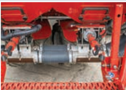
Αμφότερες οι μονάδες μέτρησης μπορούν να διανείμουν τα προϊόντα στους σωλήνες μεταφοράς
