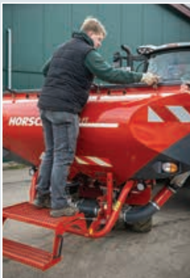
Το κεντρικό σύστημα κλειδώματος για το κάλυμμα είναι βελτιωμένο.
