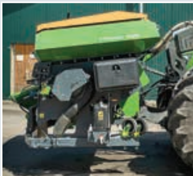
Το τμήμα αποθήκευσης, πλυσίματος χειρών, TwinTerminal και τα καστέρ.
