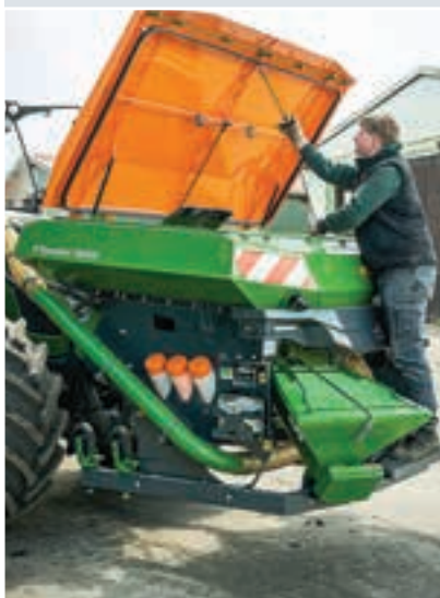
Παρά το μέγεθος του, το κάλυμμα είναι εύκολο στη λειτουργία. Ένα γομάτινο σφράγισμα θα ήταν ιδανικό.
