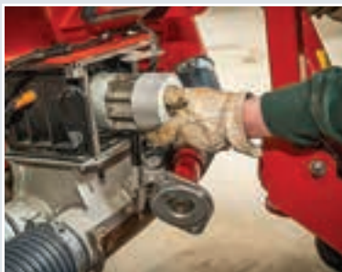
Για αλλαγή του ρότορα από μπροστά πρώτα πρέπει να αφαιρεθεί ο κινητήρας οδήγησης
