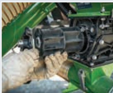
Ο ρότορας μέτρησης μπορεί εύκολα να αφαιρεθεί.
