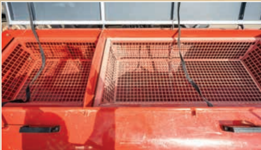
Η Horsch ήταν η μόνη στη δοκιμή που διέθετε σπαστή χοάνη.
