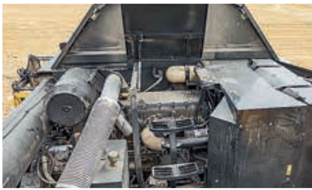
Στο παρελθόν: ένας κινητήρας χωρίς ακαταστασία, χωρίς μετεπεξεργασία καυσαερίων στο CX860 (αριστερά) ...
