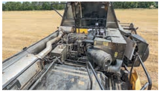
... ενώ ο κινητήρας του CX8.90 διαθέτει DOC και SCR. Η πρόσβαση στο χώρο του κινητήρα εξακολουθεί να γίνεται από τα δεξιά.
