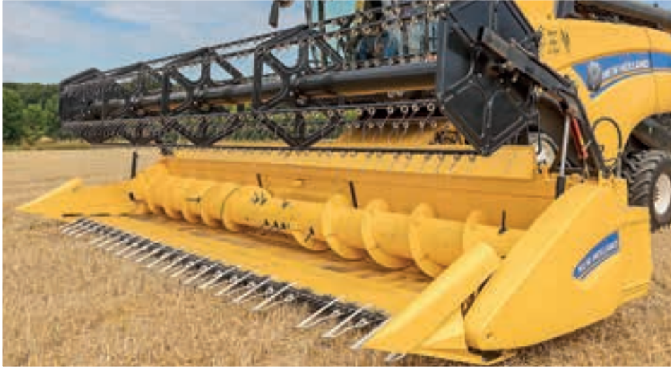
Το Varifeed με ρυθμιζόμενη θέση μαχαιριού είναι πλέον διαθέσιμο σε πλάτος έως 12,50 μ.
