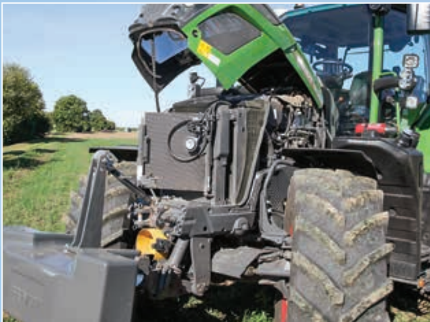
Ο τετρακύλινδρος κινητήρας είναι η μονάδα Core 50 της AgcoPower, 5 λίτρων.
