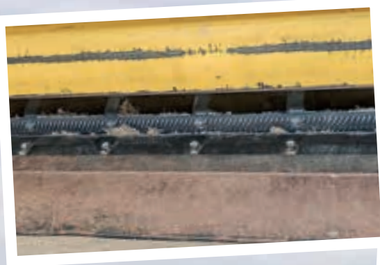
Η μονάδα αλωνισμού τεσσάρων τυμπάνων CX860 με τύμπανο διαμέτρου 75 εκατοστών. Το εμβαδόν του κοίλου είναι 2,54m 2 .
