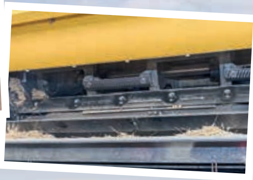
Το τύμπανο αλωνισμού Ultra-Flow του CX8.90 προσφέρει ομαλότερη ροή της σοδειάς και υψηλότερη απόδοση.
