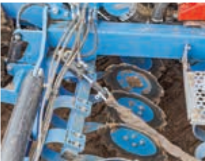
Η αλυσίδα είναι τεντωμένη για τη μεταφορά δυνάμεων πίσω στο πλαίσιο.
