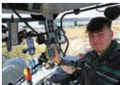
Ο χειριστής της αντλίας διατηρεί επαφή με τον Mathew μέσω ασυρμάτου. Τις βαλβίδες αντλίας ελέγχει ο τηλεχειρισμός...
