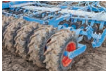
Ένας εμπρόσθιος συσκευαστής βοηθά, στον ομοιόμορφο έλεγχο του βάθους.
