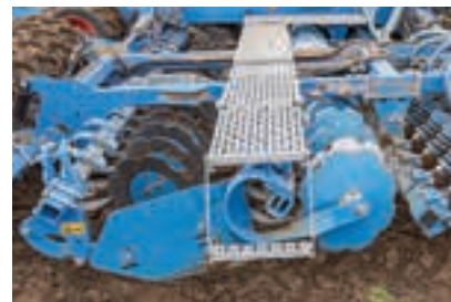
Η πλαϊνή πλάκα και τα σκαλοπάτια πρέπει να διπλωθούν χειροκίνητα πριν το δρόμο.
