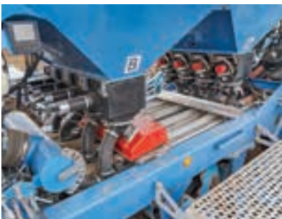
Καθεμιά από τις τέσσερις μονάδες κάτω από κάθε χοάνη έχει δικό της σωλήνα παροχής σε ξεχωριστό διανομέα.
