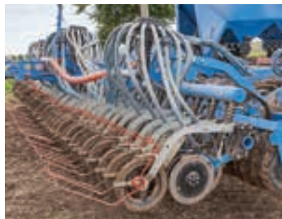
Μπροστά από τα διπλού δίσκου μαχαίρια σποράς υπάρχει χώρος για έναν τραπεζοειδή κύλινδρο.
