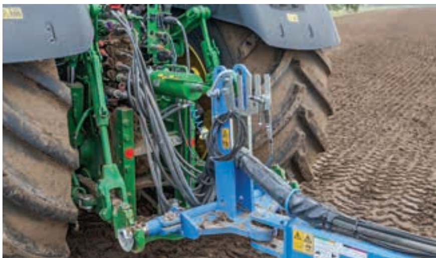
Μία από τις επιλογές πρόσδεσης είναι αυτή η κεφαλή τριών σημείων, η οποία μετατοπίζει το σημείο περιστροφής ελαφρώς πιο πίσω. Η ομάδα της δοκιμής δεν αντιμετώπισε σημαντικά προβλήματα με την τοποθέτηση ή την αφαίρεση του μεγάλου Solitair.
