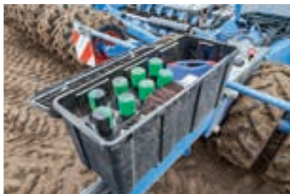
Το κουτί αποθήκευσης συγκρατεί τους τροχούς μέτρησης και έχει και άλλο χώρο.
