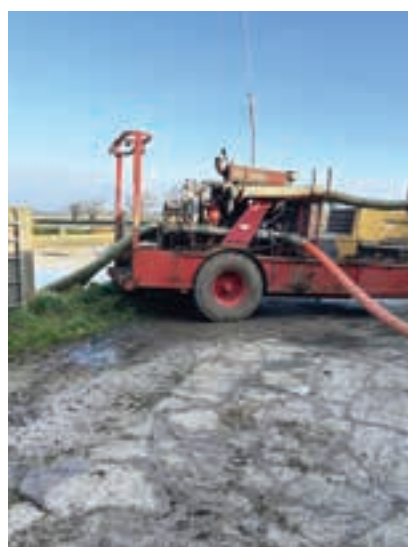
Η άντληση Storth διαθέτει δικό της κινητήρα και συμπιεστή. Ο δεύτερος χειριστής συνεχίζει απρόσκοπτα με το τρακτέρ μετά.
