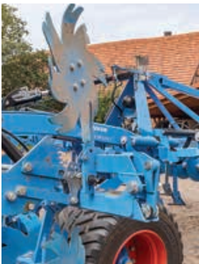
Ο εξωτερικός δίσκος αναδιπλώνεται αυτόματα από «πέδιο» σε «δρόμο».
