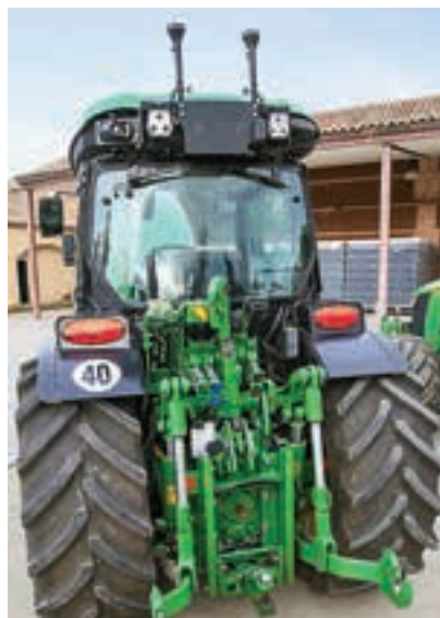
Καμία έλλειψη ανυψωτικής δύναμης και υδραυλικής απόδοσης στο 5ML. Ωστόσο, όλα τα οπίσθια καρούλια είναι μηχανικά.
