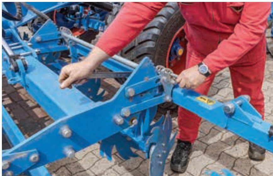
Το βάθος των δίσκων ισοπέδωσης ρυθμίζεται με δύο διαφορετικούς προσαρμοστές.
