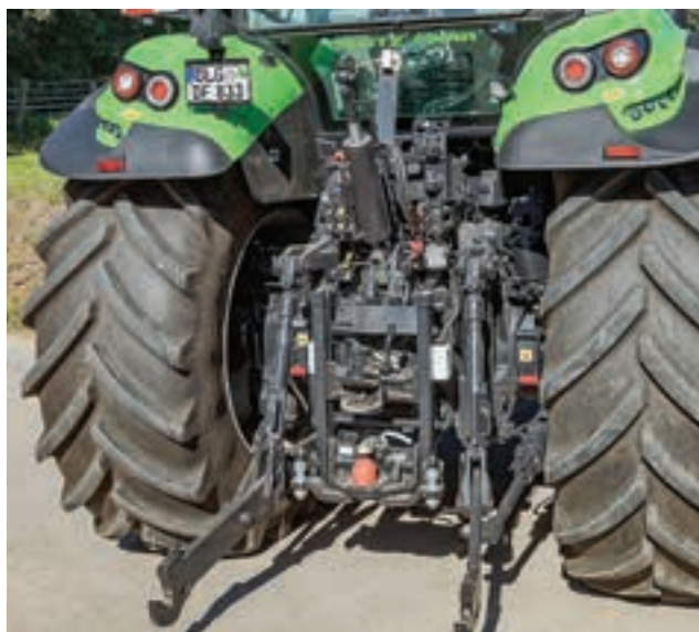
Το 6190 TTV διαθέτει άφθονη ανυψωτική και υδραυλική ισχύ. Οι βαλβίδες δεν διαθέτουν μοχλούς ανακούφισης πίεσης όμως.
