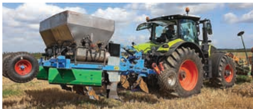
Μπροστά, τα τροποποιημένα σώματα αρότρων ανασπώνουν την κορυφή του οριζοντα-A και το σπρώχνουν στο πλάι μέχρι τα δόντια να σπρώξουν το κομπόστ βαθιά στον οριζοντα-B.
