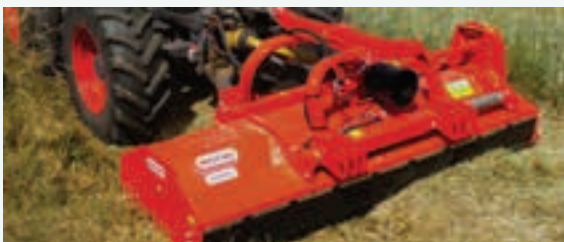
Καταστροφέας κλαδιών και υπολειμμάτων καλλιέργειών CHIARA με διαθέσιμες εκδόσεις από 160 έως 250 μέτρα πλάτος εργασίας.
