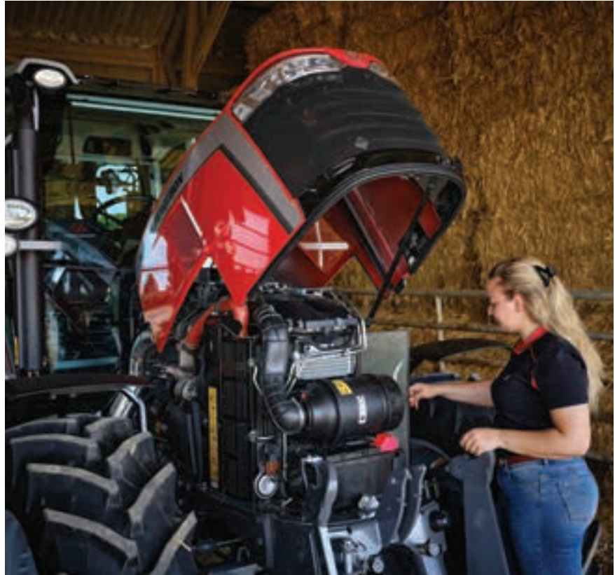
Τα έξι μοντέλα της γκάμας τροφοδοτούνται από τους τελευταίους τετρακύλινδρους κινητήρες AGCO Power που πληρούν τους αυστηρότερους κανονισμούς εκπομπών Stage V.
