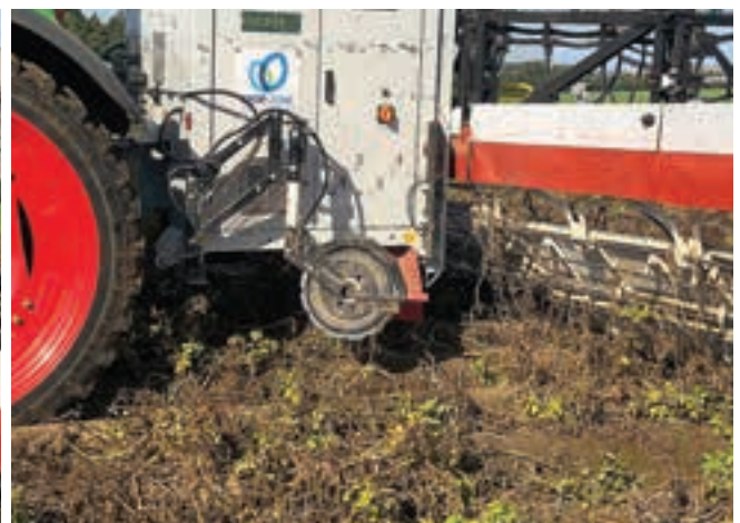
Το σύστημα διαθέτει τρόπους γείωσης σε περίπτωση κάποιας βλάβης. Όταν οι δίσκοι σπκώνονται τότε το ρεύμα κόβεται.
