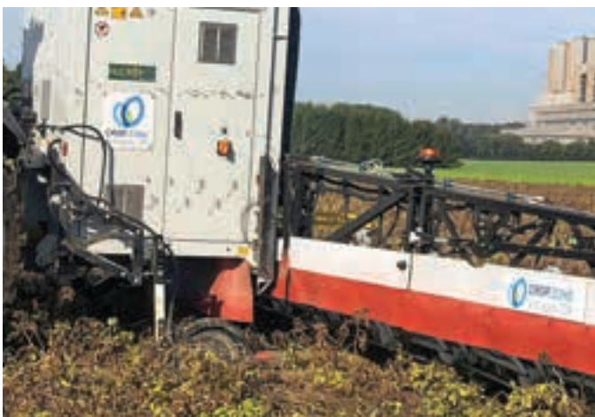
Το σύστημα διαθέτει τρόπους γείωσης σε περίπτωση κάποιας βλάβης. Όταν οι δίσκοι σπκώνονται τότε το ρεύμα κόβεται.
