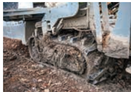
Το 170 ίππων τρίκυκλο στρίβει με ένα σήμα RTK. Ερπύστριες αντικαθιστούν τα πίσω ελαστικά, επιτρέποντας την λειτουργία υπό βροχή.
