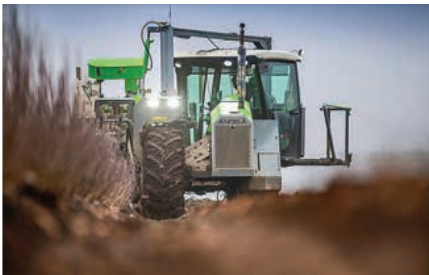
Το 170 ίππων τρίκυκλο στρίβει με ένα σήμα RTK. Ερπύστριες αντικαθιστούν τα πίσω ελαστικά, επιτρέποντας την λειτουργία υπό βροχή.
