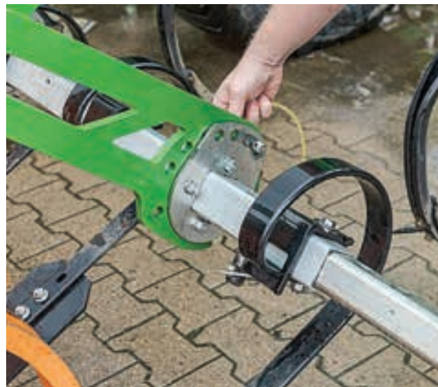
Μπορείτε εύκολα να περιστρέψετε τη γωνία των εργαλείων ισοπέδωσης απλά αλλάζοντας τη θέση μιας βίδας ή ενός πείρου.
