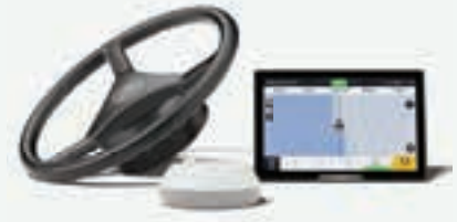
Πάνω αριστερά: Έξυπνος σχεδιασμός διαδρομών για διάφορα σενάρια. Πάνω δεξιά: Σύστημα αυτόματης πλοήγησης FJD AT2 που συνδυάζει GNSS και RTK για να εγγυηθεί ακρίβεια 2,5cm.
