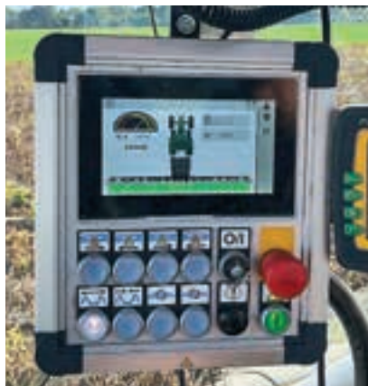
Τα στοιχεία εφαρμοστή και η κατάστασή τους, παρακολουθούνται μέσα από την καρμπίνα.
