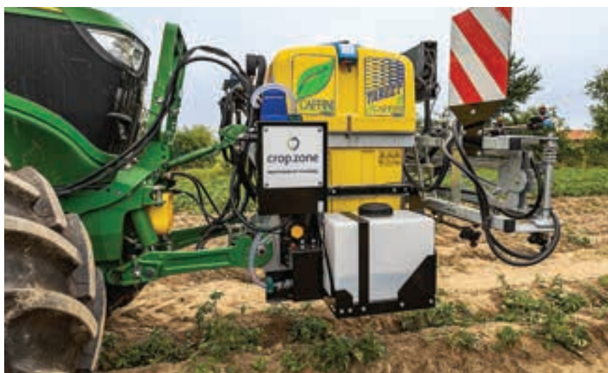
Το αγωγίμο διάλυμα Volt.Fuel μετράται απευθείας από ξεχωριστό ρεζερβουάρ 50 λίτρων.
