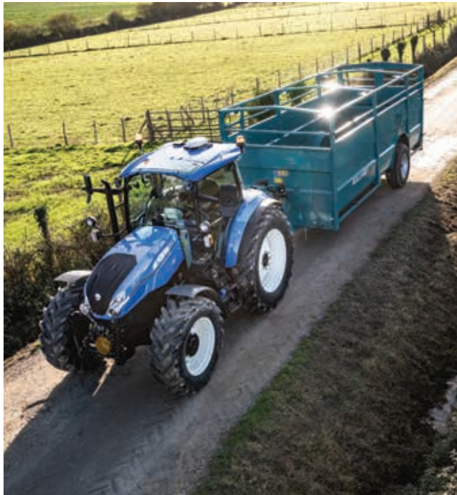
Εξωτερικά τα νέα T5 τρακτέρ διαθέτουν φρέσκο στυλ με νέες μπροστινές και πλαϊνές γρίλιες, συν νέα αυτοκόλλητα που ταιριάζουν και με τα άλλα ανανεωμένα μηχανήματα της New Holland. Μία νέα εξάτμιση σε σχήμα «U», εξασφαλίζει ανεμπόδιστη ορατότητα μπροστά.
