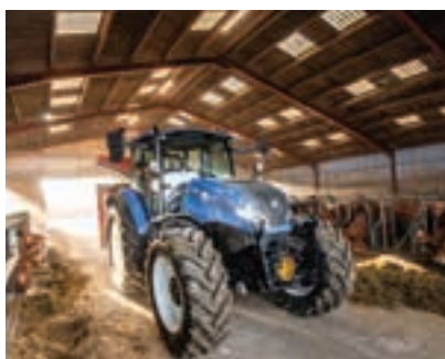
Εξωτερικά τα νέα T5 τρακτέρ διαθέτουν φρέσκο στυλ με νέες μπροστινές και πλαϊνές γρίλιες, συν νέα αυτοκόλλητα που ταιριάζουν και με τα άλλα ανανεωμένα μηχανήματα της New Holland. Μία νέα εξάτμιση σε σχήμα «U», εξασφαλίζει ανεμπόδιστη ορατότητα μπροστά.
