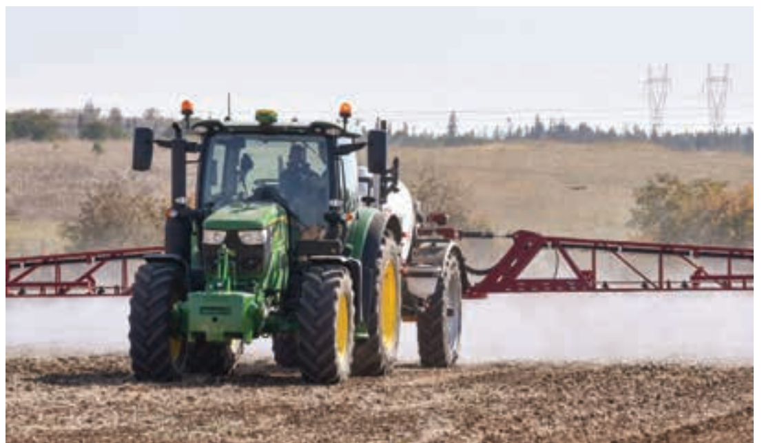
Το τρακτέρ John Deere 6R 120 είχε εξοπλιστεί με το σύστημα γεωργίας ακριβείας και αυτόματης καθοδήγησης John Deere Starfire 6000, με ακρίβεια ενός εκατοστού και ηλεκτροδραυλικό τάκο.
